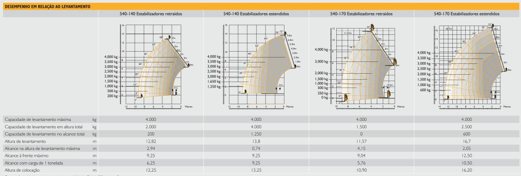
Em conformidade com o teste de estabilidade EN 1459 Anexo B.
